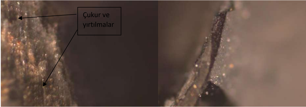
Şekil 65b. Takım aşınması Leika mikroskop görüntüleri.
