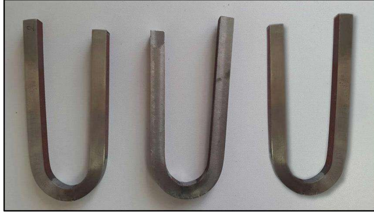
Şekil 4. Eğme testi sonucu elde edilen görüntü
