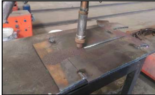
Şekil 1. Kaynak esnasında puntalanmış numune görüntüsü
