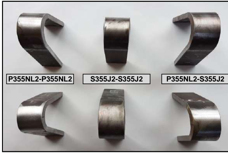
Şekil 6. Eğme testi sonrası numunelerin görüntüsü.
