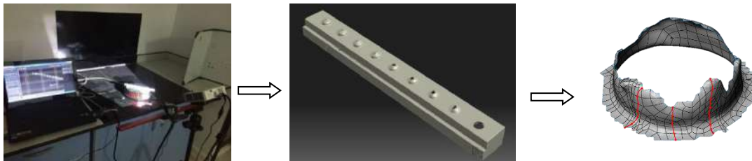
Şekil 3. Delme İşleminin Yapıldığı Numunenin Taranması ve CAD Formatına Dönüştürülmesi
