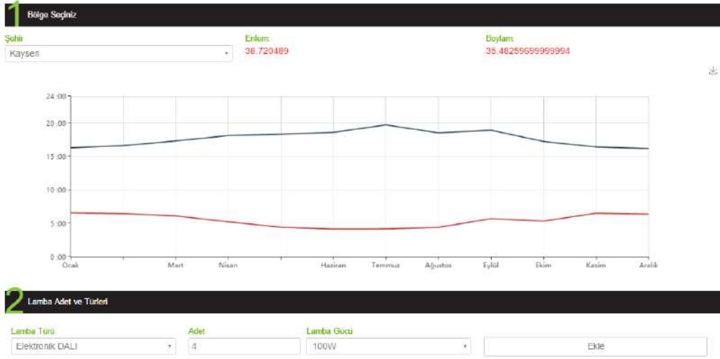
Şekil 3. 4 adet 100W DALI dimli LED armatür için yapılacak 1 yıllık enerji tasarrufu
