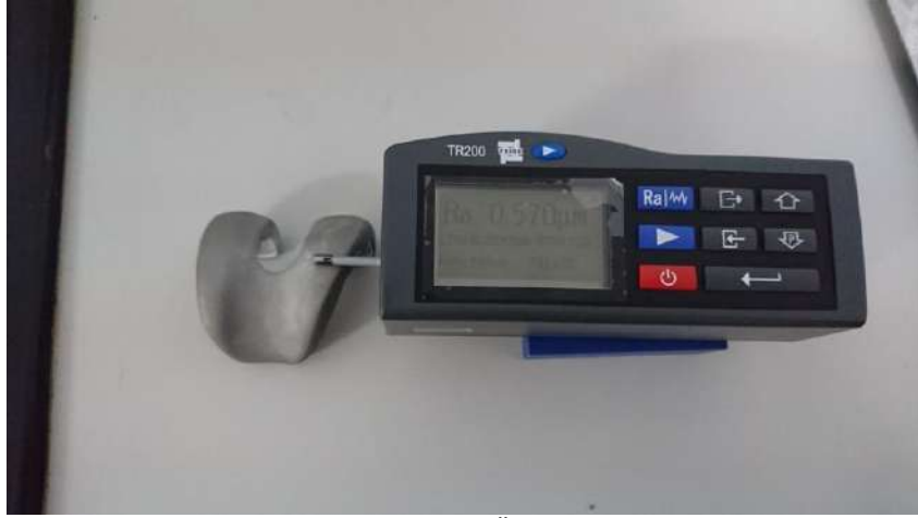
Şekil 2. Pürüzlülük Ölçüm Yöntemi
