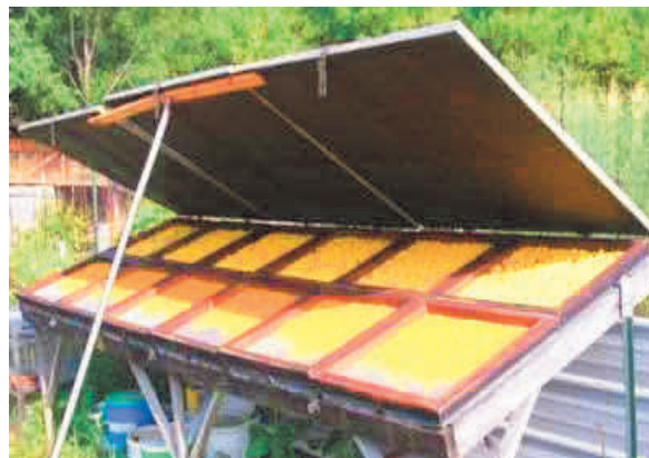
Şekil 11. Güneş enerjisi ile kurutma sistemi (Güneş Enerji Sistemleri, 2022)
